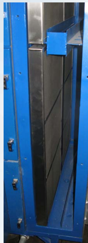
Extra voorfiltersectie 2 x 50 mm inox filters, eenvoudig te verwijderen voor reiniging.
